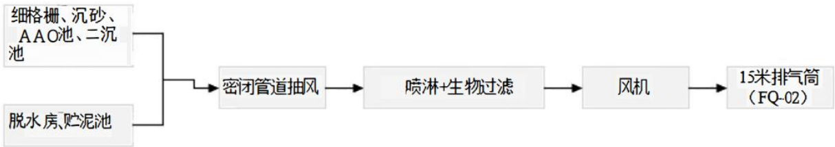
图 4-1 废气处理工艺流程图
